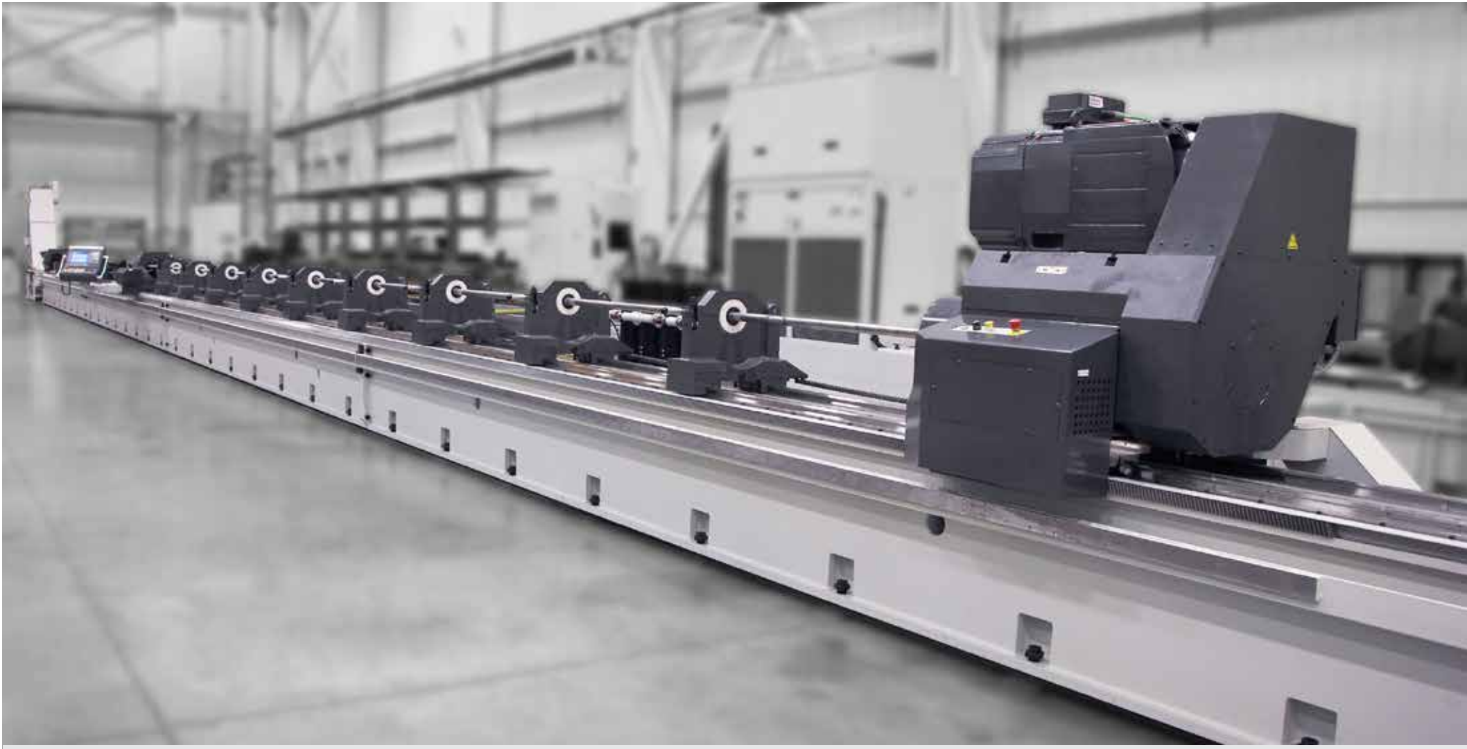
UNISIG S-Series skiving and roller burnishing machine, used to produce precision bores up to 42 ft [13 meters] deep UNISIG S-Serie Schäl- und Glattwalzmaschine, eingesetzt für Präzisionsbohrungen bis 13 m [42 ft] Bohrtiefe
