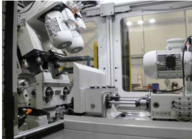
UNISIG UNI-Series automated machine for high volume production cell to manufacture power train components UNISIG UNI-Serie Maschine mit Automatisierung für Großserienfertigung von Antriebskomponenten
