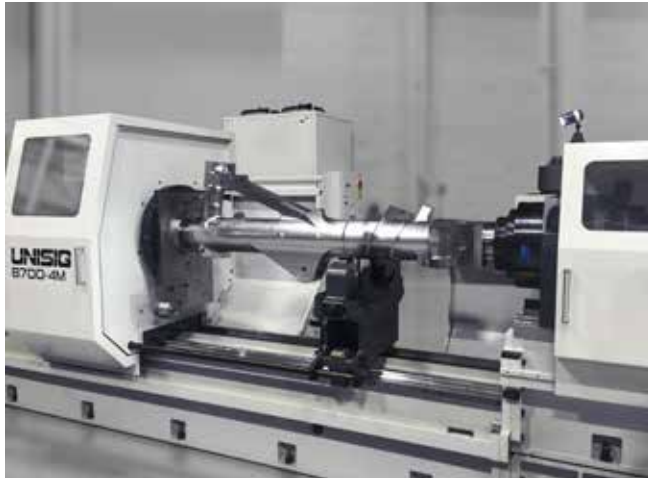
UNISIG B700 BTA machine with drop bed to swing up to 63 in [1600 mm] for commercial landing gear UNISIG B700 BTA Maschine mit Tiefbett und Umlauf von 1.600 mm [63 in] für Fahrwerke von Verkehrsflugzeugen
