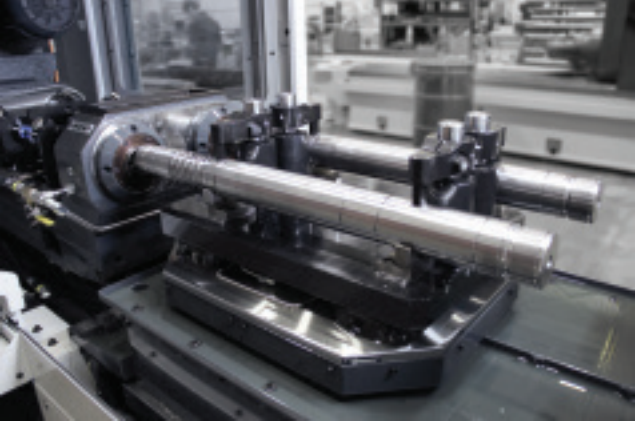
Posicionamiento CNC, movimiento rotativo y Dispositivos de Sujeción modulares disponibles para operaciones de perforación complejas en producción
