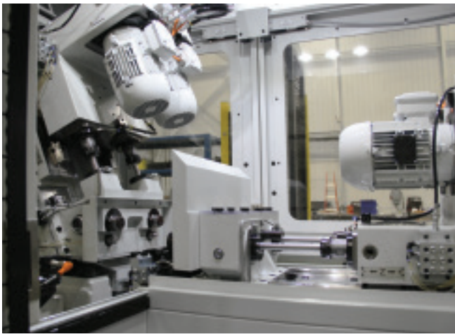
Máquina automatizada de la serie UNI de UNISIG para una célula de producción de gran volumen para fabricar componentes tracción
