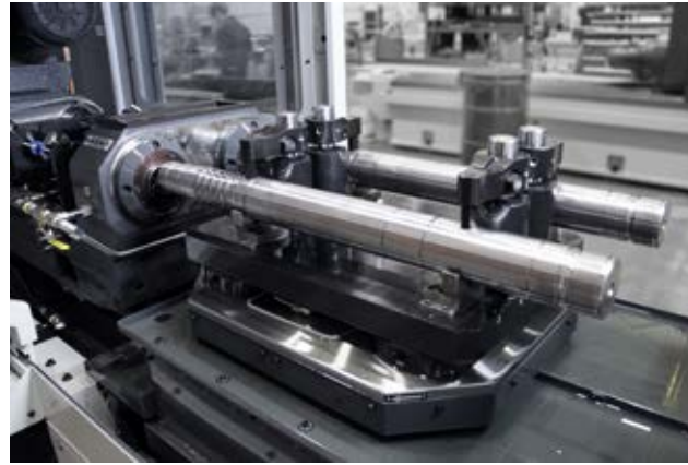
CNC positioning, rotary motion and modular workholding are available for complex drilling operations in production Für komplexe Bohrvorgänge in der Produktion stehen CNC-Positionierung, Drehbewegung und modulare Werkstückspannung zur Verfügung
