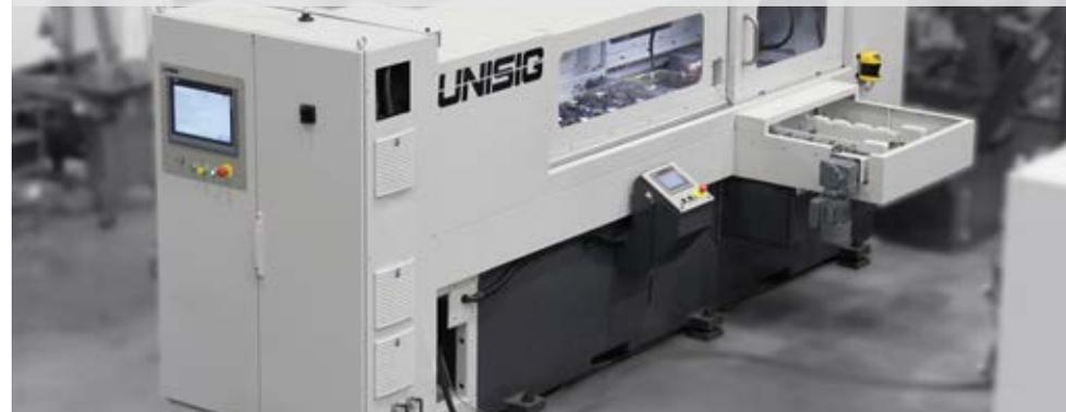
Perforado profundo de Barras con agujeros que requieren alta rectitud y concentricidad, desde 3 mm a 12 mm [0.12 in a 0.50 in] de diámetro, y hasta 750 mm [30 in] de profundidad.
