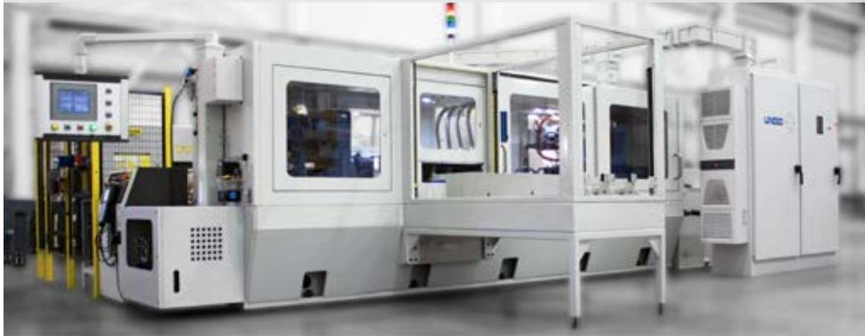
Potente máquina de cuatro husillos para la perforación con brocas tipo BTA para producción de agujeros desde 12 mm a 25 mm [0.47 in a 1.0 in] de diámetro hasta 750 mm [30 in] de profundidad.
