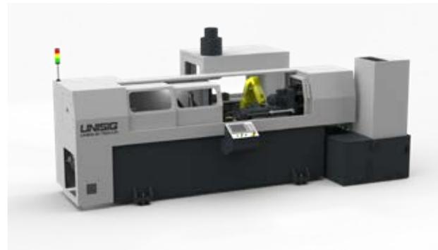
Las configuraciones UNE6 ofrecen disposiciones de un solo husillo o de dos husillos independientes, con la opción de estar preparadas para el robot o con el robot integrado.
