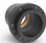
**Los cabezales de presión** localizan la pieza, guían la broca e introducen el fluido de corte en la operación. El cabezal de presión es un componente crítico en un proceso BTA preciso.
