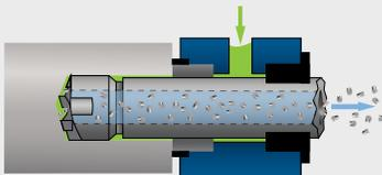
El barrenado profundo se realiza de forma productiva utilizando una variedad de herramientas diferentes, determinadas por los objetivos de tolerancias finales y las condiciones de las piezas de trabajo
