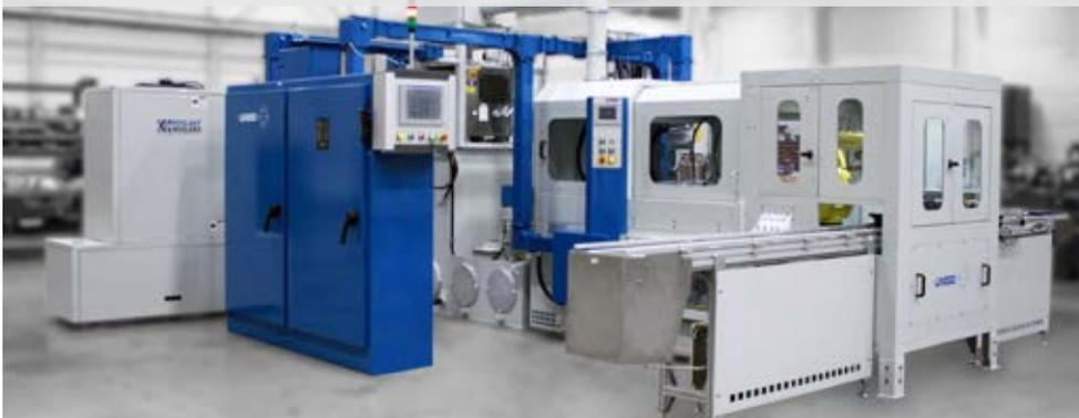
Barrenado con Bocas tipo Cañón de alta precisión para piezas pequeñas con múltiples orificios descentrados y en ángulo desde 0.8 mm a 6 mm [0.03 in a 0.25 in] de diámetro hasta 150 mm [6.0 in] de profundidad.
