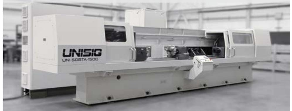
Máquina versátil y de alta precisión para orificios centrales de hasta 65 mm [2.6 in] de diámetro y 1,500 mm [60 in] de profundidad en los materiales más resistentes, utilizando Brocas tipo Cañón o BTA.
