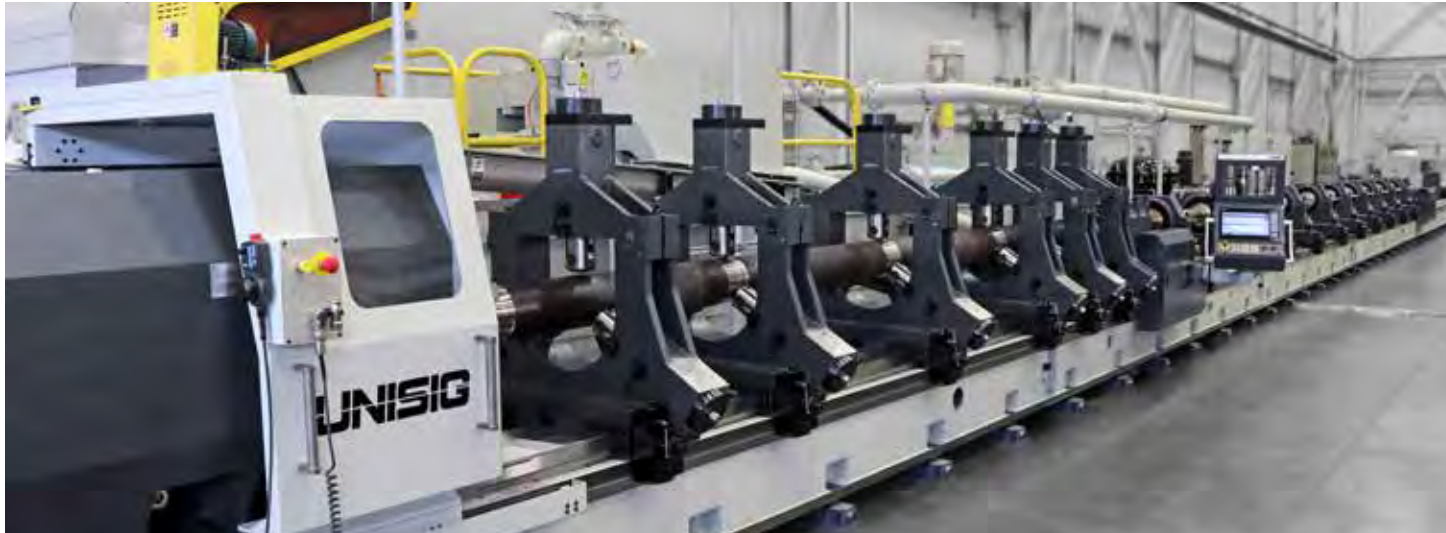
UNISIG B850-12M extreme depth BTA drilling machine, designed to drill 12.2 meters deep UNISIG B850-12M BTA Tiefbohrmaschine für extreme Bohrtiefen, ausgelegt für Bohrungen bis 12,2 m Tiefe
