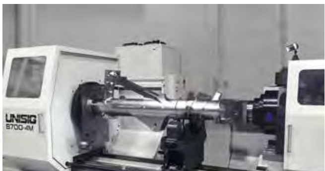
UNISIG B700 BTA machine with drop bed to increase swing-over bed to 1,600 mm for commercial landing gear UNISIG B700 BTA Maschine mit erhöhtem Umauf von 1.600 mm über abgesetztem Bett für Fahrstellkomponenten
