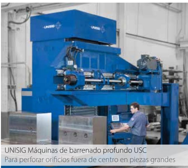
UNISIG Máquinas de barrenado profundo USC
