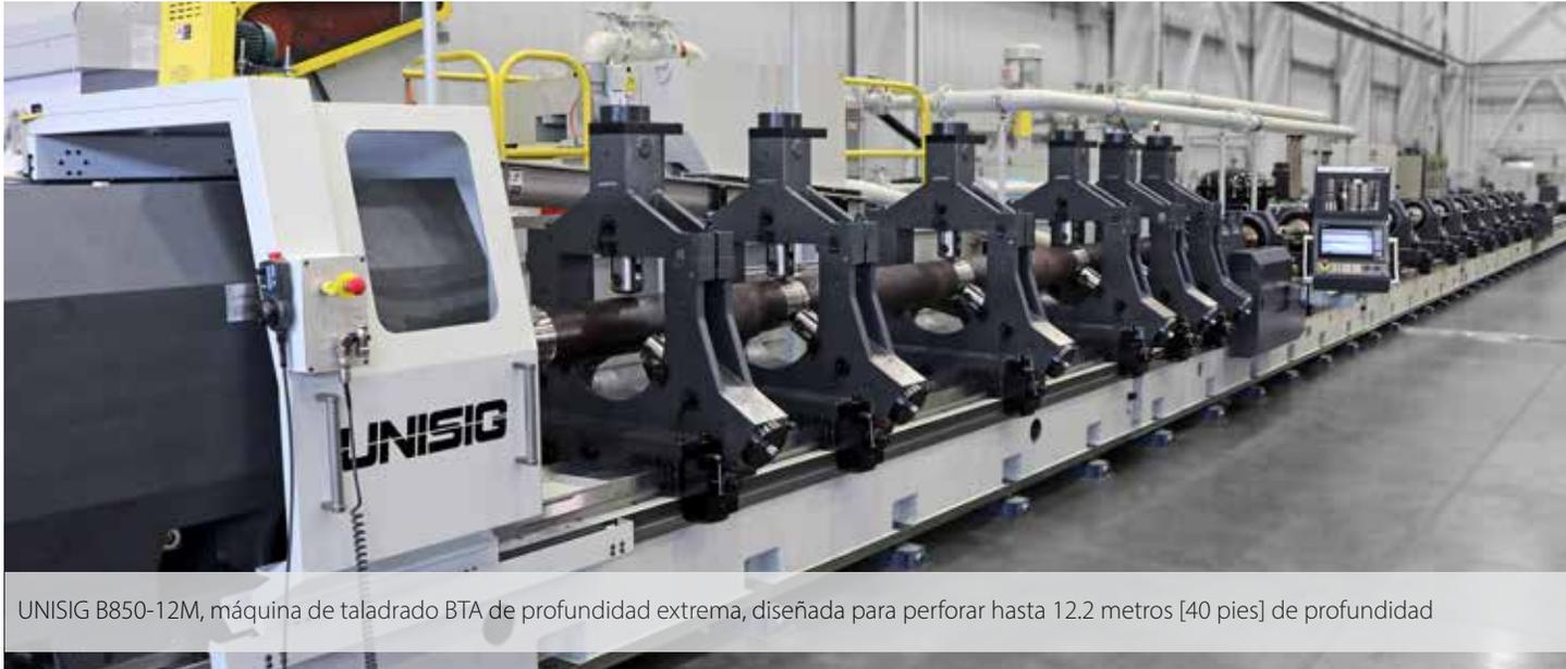
UNISIG B850-12M, máquina de taladrado BTA de profundidad extrema, diseñada para perforar hasta 12.2 metros [40 pies] de profundidad
