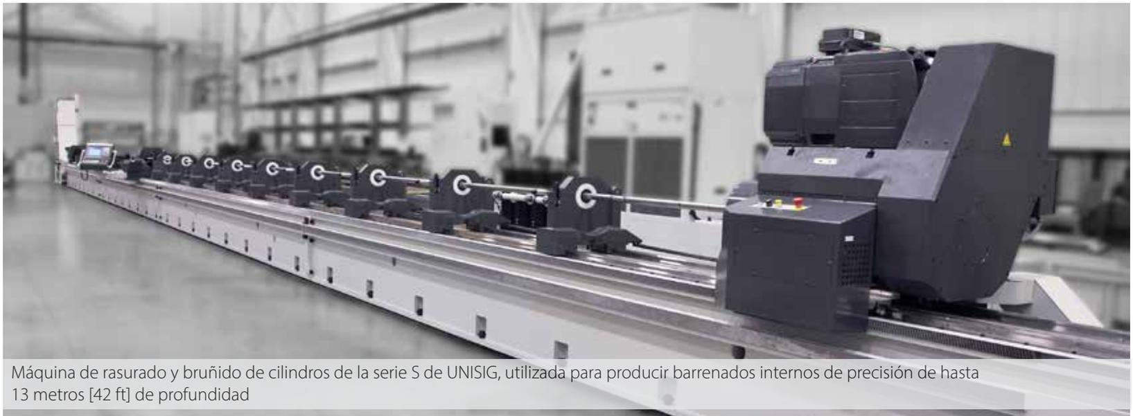
Máquina de rasurado y bruñido de cilindros de la serie S de UNISIG, utilizada para producir barrenados internos de precisión de hasta 13 metros [42 ft] de profundidad
