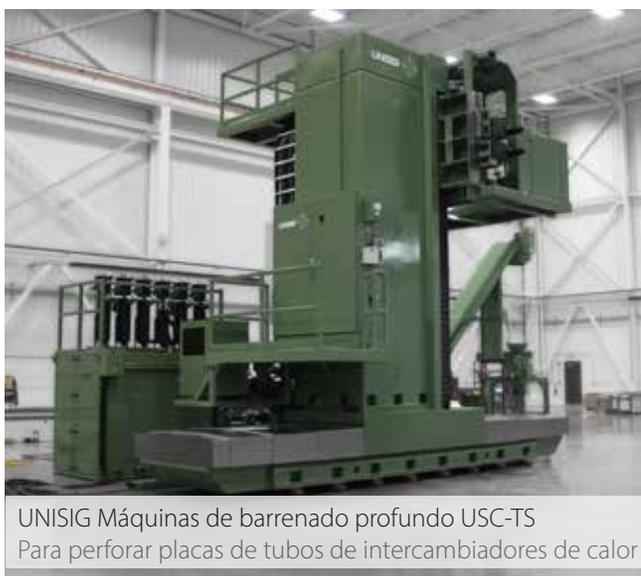
UNISIG Máquinas de barrenado profundo USC-TS
