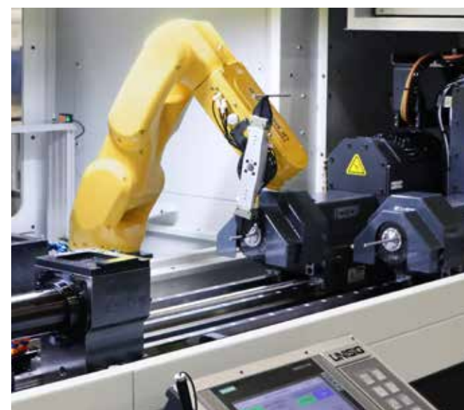
Las configuraciones UNE6 ofrecen disposiciones de un solo husillo o de dos husillos independientes, con la opción de estar preparadas para el robot o con el robot integrado.
