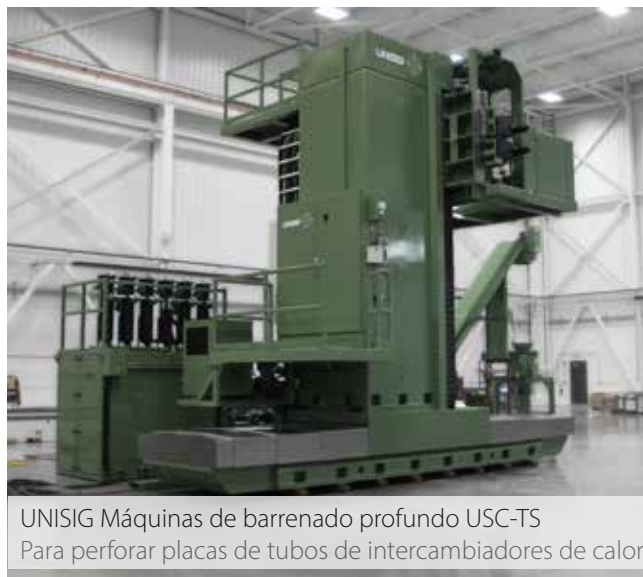
UNISIG UNI-25-2-3000-CR, máquina de taladrado profundo para piezas de 3,000 mm [120 pulgadas] de largo, con sujeción y posicionamiento automatizados de las piezas de trabajo
