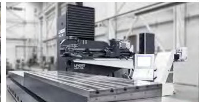
UNISIG USC BTA drilling machine with 50-taper milling spindle and special capacity table UNISIG USC BTA Tiefbohrmaschine mit 50er Frässpindelaufnahme und speziellem Aufnahmetisch
