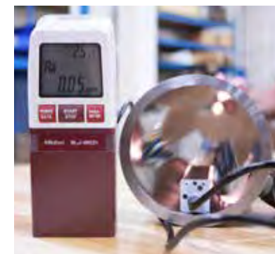
Actual results from UNISIG skiving and roller burnishing machine Bearbeitungsergebnis einer UNISIG Schäl- und Glattwalzmaschine
